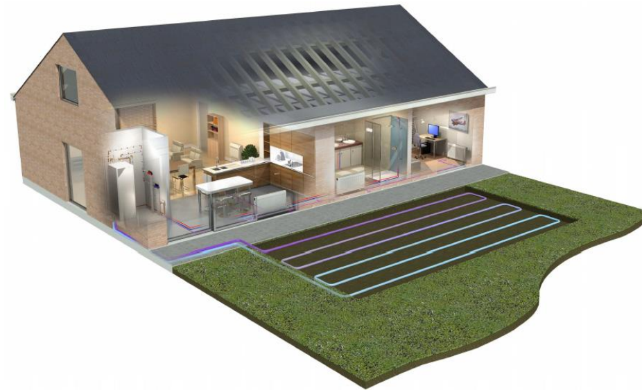
Sustav s horizontalnim kolektorom
